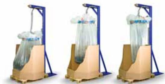
El sistema automático de elevación de sacos tira de las paredes flexibles del contenedor hacia arriba y hacia dentro. En consecuencia, el saco se estrecha y el material de los bordes cae hacia el punto de succión central. Cuando termina la descarga el contenedor se levanta del suelo, permitiendo que se vacíen completamente los restos.
